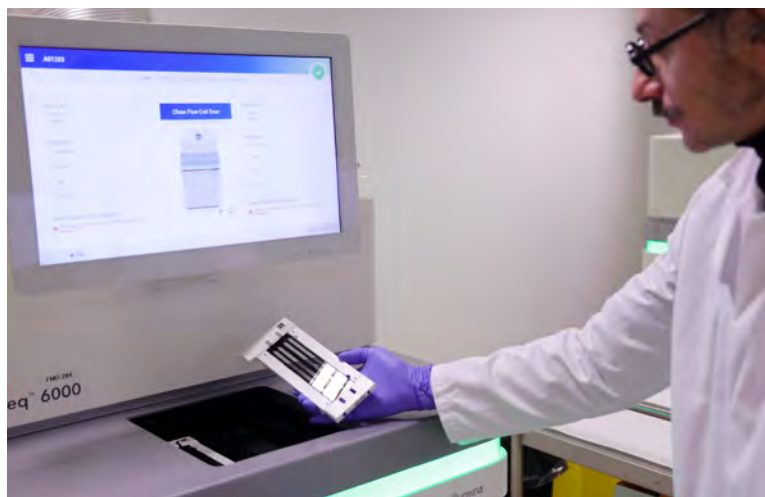
Chargement d'une puce de séquençage de très haut débit, CGS SeqOIA
